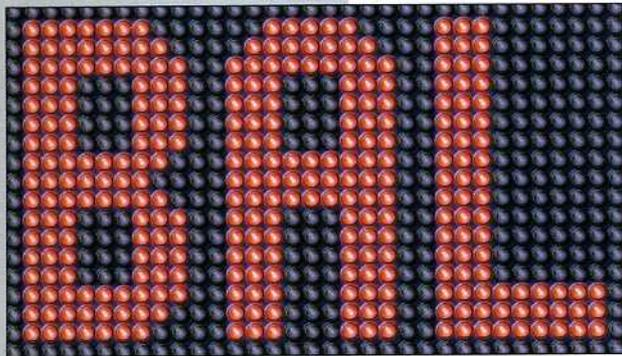
D'ENCOMBRANTES RANGÉES de relais électromécaniques étaient autrefois utilisés pour animer ce type de panneau. Les allumages étaient produits par une bande de papier perforé qui défilait entre deux rangées de palpeurs. Un trou établissait le contact et l'ampoule s'allumait momentanément. Aujourd'hui, ce sont des circuits intégrés qui régissent les impulsions.
