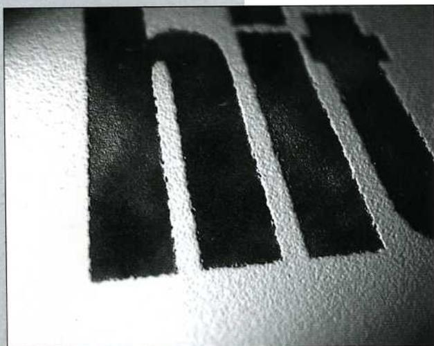
IL N'Y A PAS DE MEILLEURE IMPRESSION que celle en relief. Une pression de plusieurs tonnes est exercée sur des caractères en métal encrés qui s'enfoncent dans une feuille de papier moelleux plaquée sur une base lisse. La profondeur de l'impression est minime, mais le léger relief associé à un changement de texture fait la différence.
